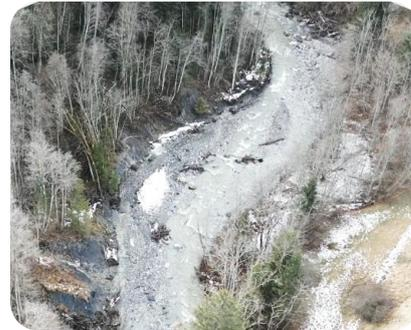
Autre exemple de réduction d'un embâcle dans le Glapet à Megève, qui permet de maintenir la stabilité du fond du lit ayant tendance à inciser dans des terrains argileux.
